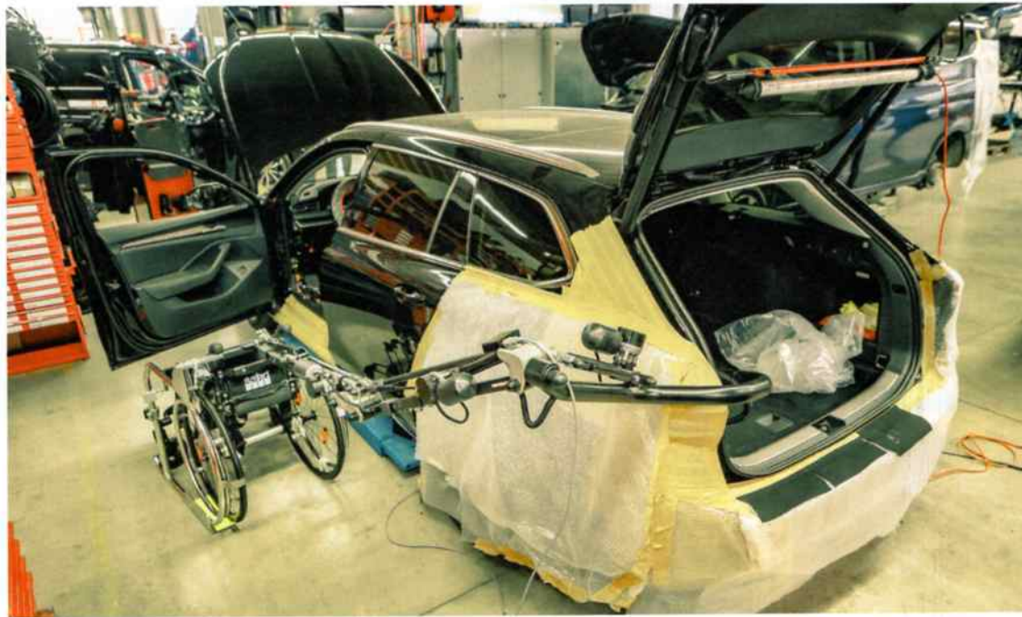
Solonummer: In diesem Umbau eines Porsche Macan wird der Rollstuhl automatisiert im Kofferraum verstaut, nachdem sich der Fahrer ans Lenkrad gehievt hat.
