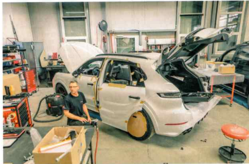
Schwerstbehinderte dürfen auch Porsche fahren: Umbau eines Macan mit Rollstuhlrampe in der Paravan-Werkstatt.
