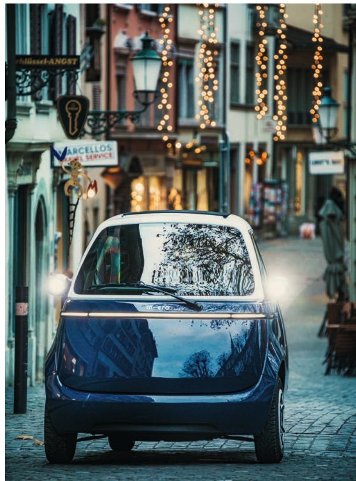
Platz ist in der kleinsten Gasse: Microlino ist 2,5 Meter lang, 1,5 Meter breit und ebenso hoch.
