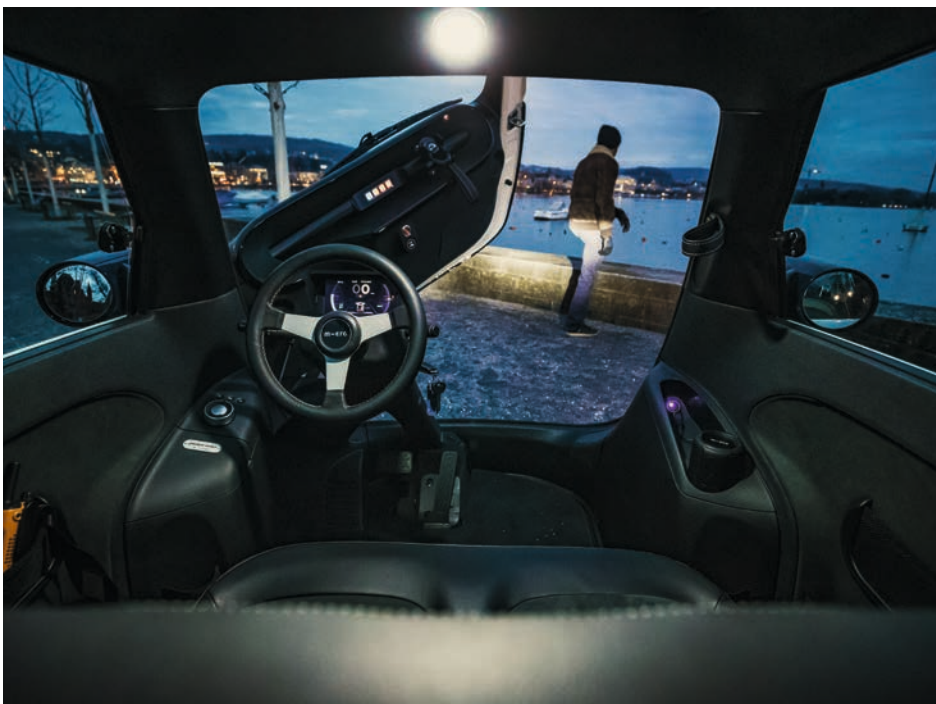
Türe als Fahrzeugfront: Links neben dem Lenkrad das Drehrädchen zum Einstellen der Fahrstufen.
